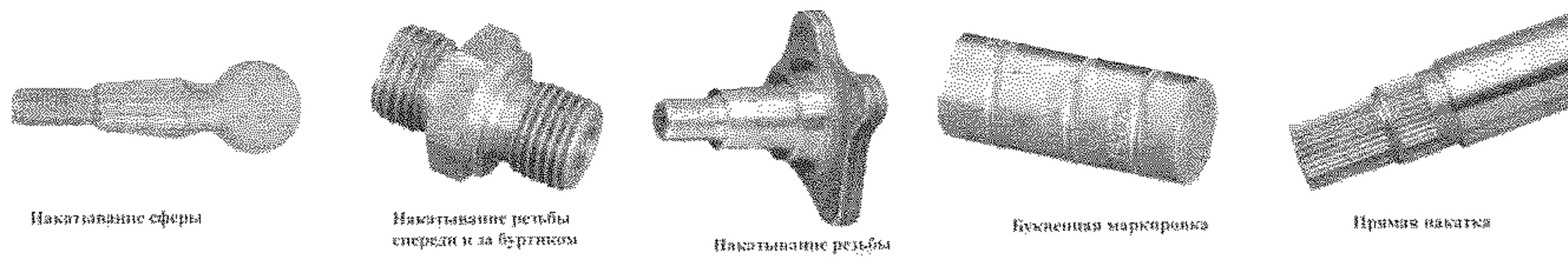
друг друга. Основными видами оборудования, на котором применяется накатывание, являются токарные станки, сверлильные стаки и токарные автоматы, включая станки с ЧПУ. Применение станков с ЧПУ для накатывания резьбы повышает эффектив-
